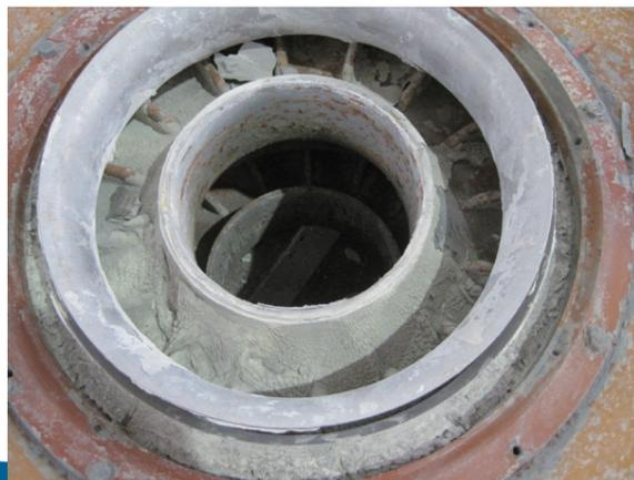
根据风机使用年限和具体故障，选择叶轮 PT 探伤、单个叶轮动平衡。
